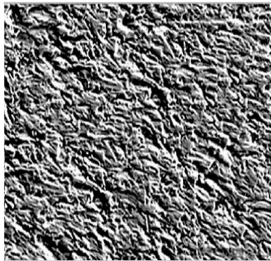
Fig. 1 Image SEM du disque d'acier après fonctionnement
