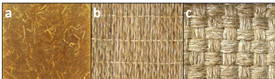
Figure 1 : différentes structures étudiées de renforts fibreux. a) fibres courtes, b) fibres longues unidirectionnelles et c) fibres longues bidirectionnelles.
