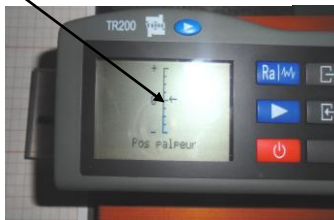
Fig.4 Position horizontale de rugosimetre
